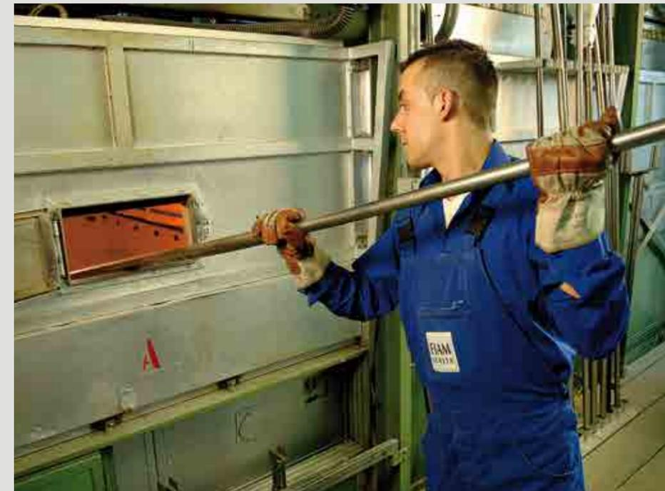
Pour transformer une plaque de verre en un objet tridimensionnel, il est nécessaire de la soumettre à un traitement thermique décliné en trois phases, chacune desquelles se déroule avec un gradient thermique défini avec précision pour chaque type de produit :
