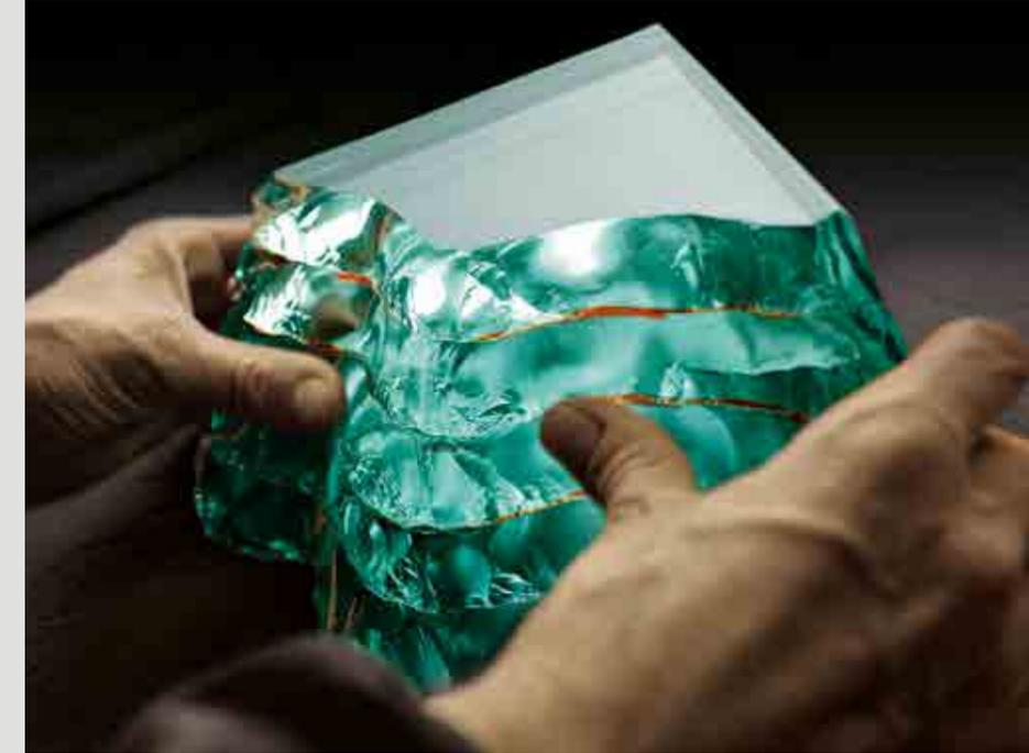
Pour assembler les éléments séparés d'un produit, Fiam utilise deux types d'en-collage : la soudure aux rayons UV et le collage silicone ou polyuréthane.
