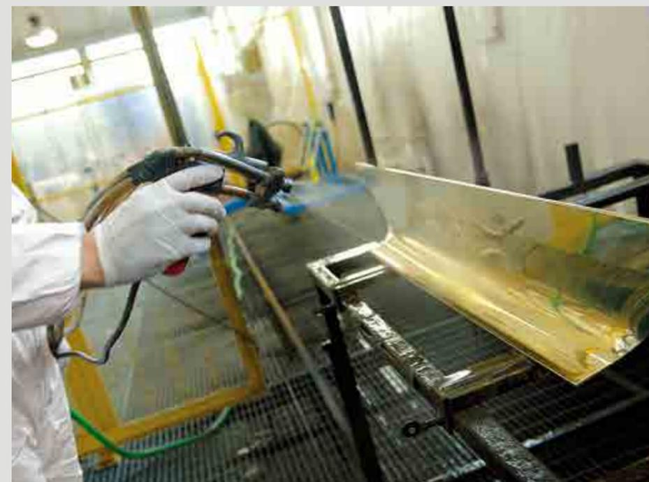
Ce procédé consiste à déposer de l'argent métallique (par précipitation de nitrate d'argent) sur les parties qui ne sont pas en contact avec l'étain. Il permet d'obtenir un verre capable de réfléchir les rayons lumineux qui frappent sa surface.
